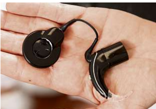
Das externe Bauteil: Ein Soundprozessor mit Mikro (r.) erfasst den Schall. Die Spule wird magnetisch auf der Haut angebracht und überträgt die digitalisierten Klänge vom Prozessor zum Implantatempfänger
