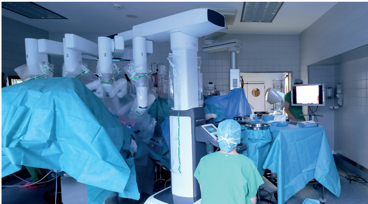
Четыре руки самого современного операционного робота Da Vinci Xi более гибки в использовании, чем жесткие эндоскопы или руки хирурга.
